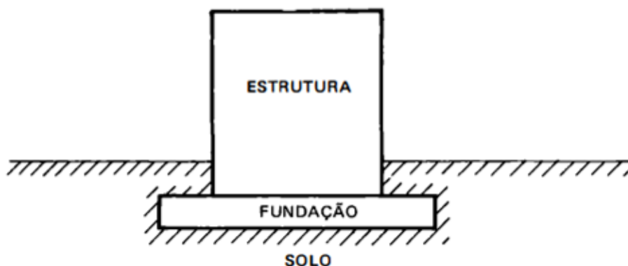
Figura 18 - Interação entre o terreno (solo) – fundação - estrutura
