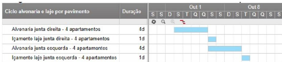
Figura 13 – Gráfico de Gantt do ciclo de alvenaria estrutural de 1 pavimento
