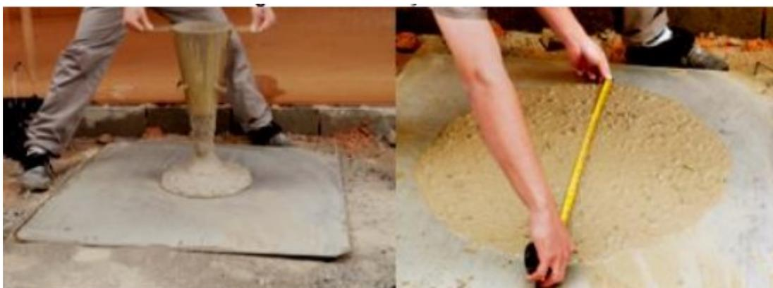
Figura 8 – Realização do Flow Test
