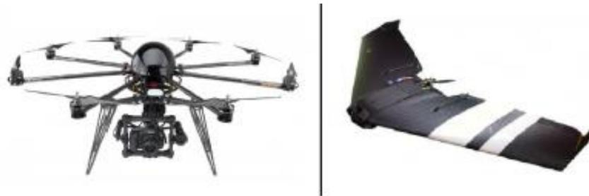
**Figura 2.1** - Modelos de VANT multirrotor (esquerda) e asa fixa (direita). (NETO *et al.*, 2017)
