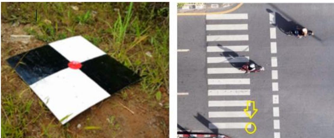
**Figura 2.2** - Exemplo de alvo confeccionado (à esquerda) e feição natural do terreno (à direita) para fins de coleta de pontos de apoio para aerofotogrametria.
