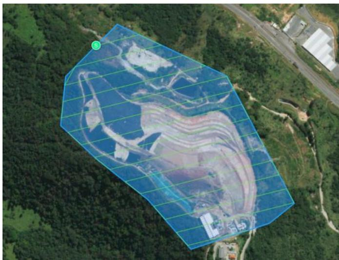
**Figura 5.3** - Plano de voo padrão adotado para coleta de imagens aéreas no aterro encerrado.
