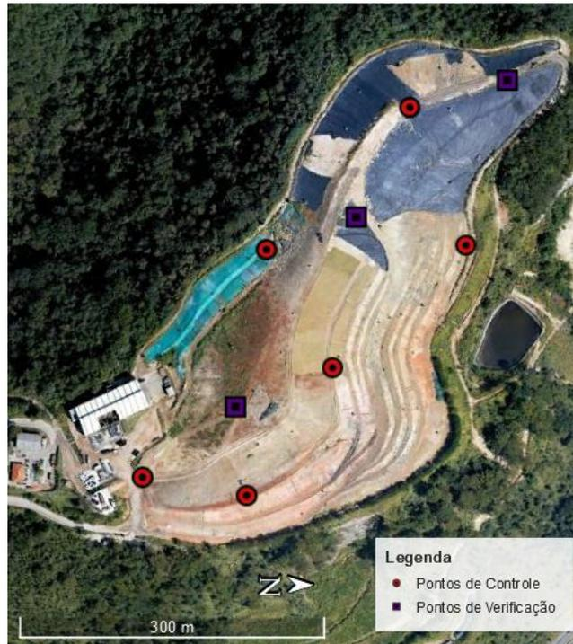
**Figura 5.2** - Distribuição geográfica dos PCs e PVs utilizados nos levantamentos do aterro encerrado.
