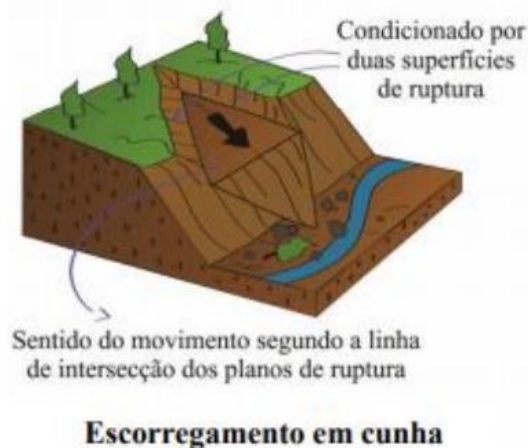
Figura 4. Escorregamento em cunha. Fonte: Brito (2014).
