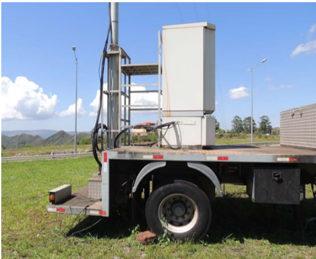
Figura 3 – Torre Móvel COW Fonte – Levantamento Técnico município de Nova Lima/MG
