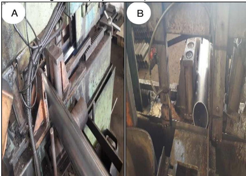
Figura 10 - Disposição dos tubos para serem serrados
