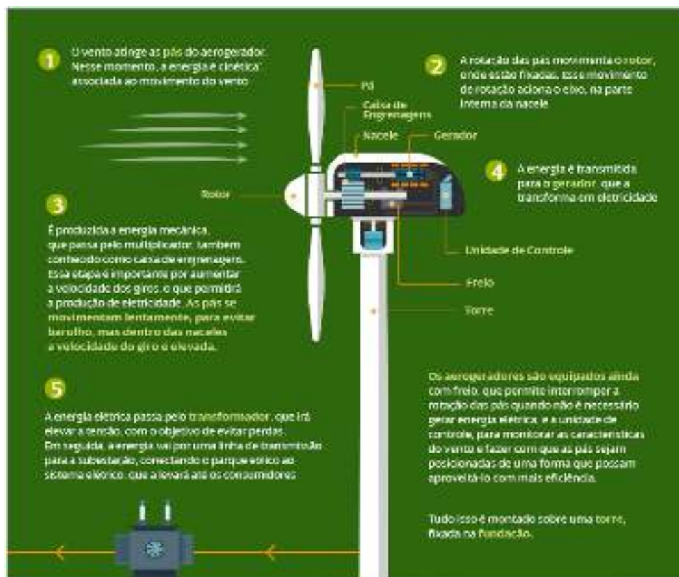
Figura 03 – Como funciona um aerogerador
