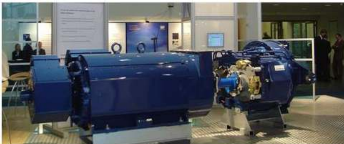
Figura 16 – Gerador conectado a uma caixa de engrenagem (Gear Box)
