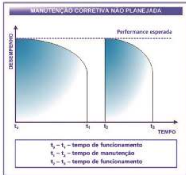
Figura 19 – Gráfico Manutenção Corretiva Não Planejada Fonte: Manutenção Função Estratégica – Alan Kardec, Júlio Nascif – 5 Edição 2019
