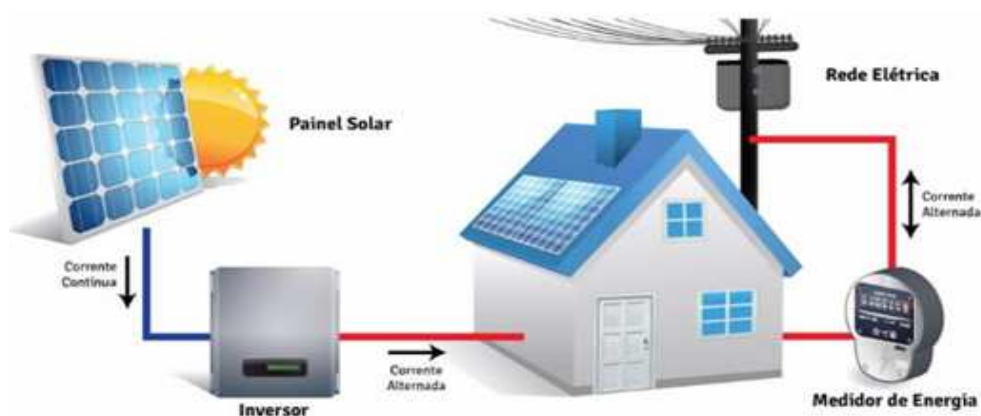
Figura 2 - Funcionamento da Energia Solar residencial
