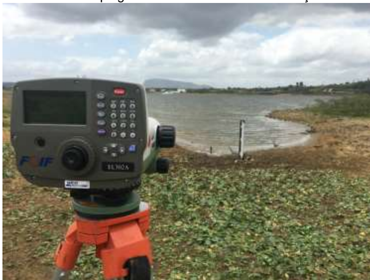
Figura 6 - Nível Topográfico - Utilizado na locação das réguas
