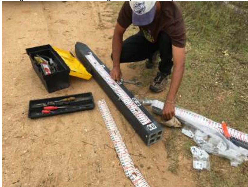
Figura 5 - Mourão e réguas para estação Hidrométrica
