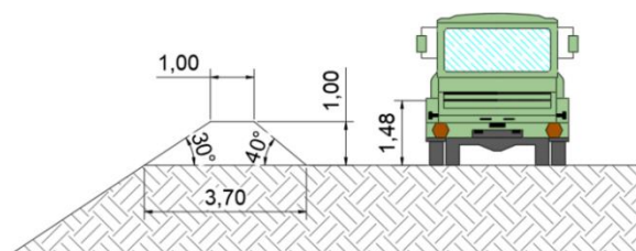
Figura 4 – Leira de proteção lateral para veículos convencionais
