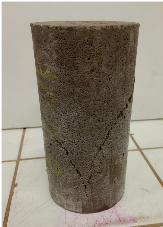
Figura 20 - Tipo de ruptura do corpo de prova.
