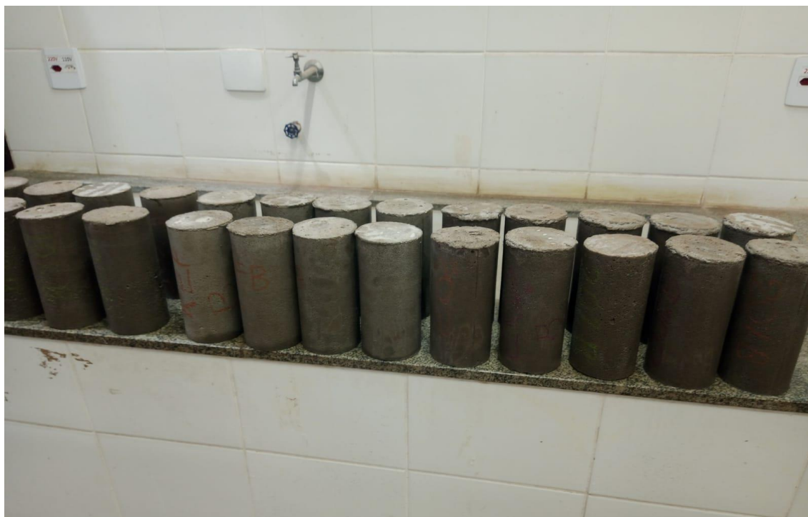
Figura 14 - Corpos de prova após 7 dias no tanque.
