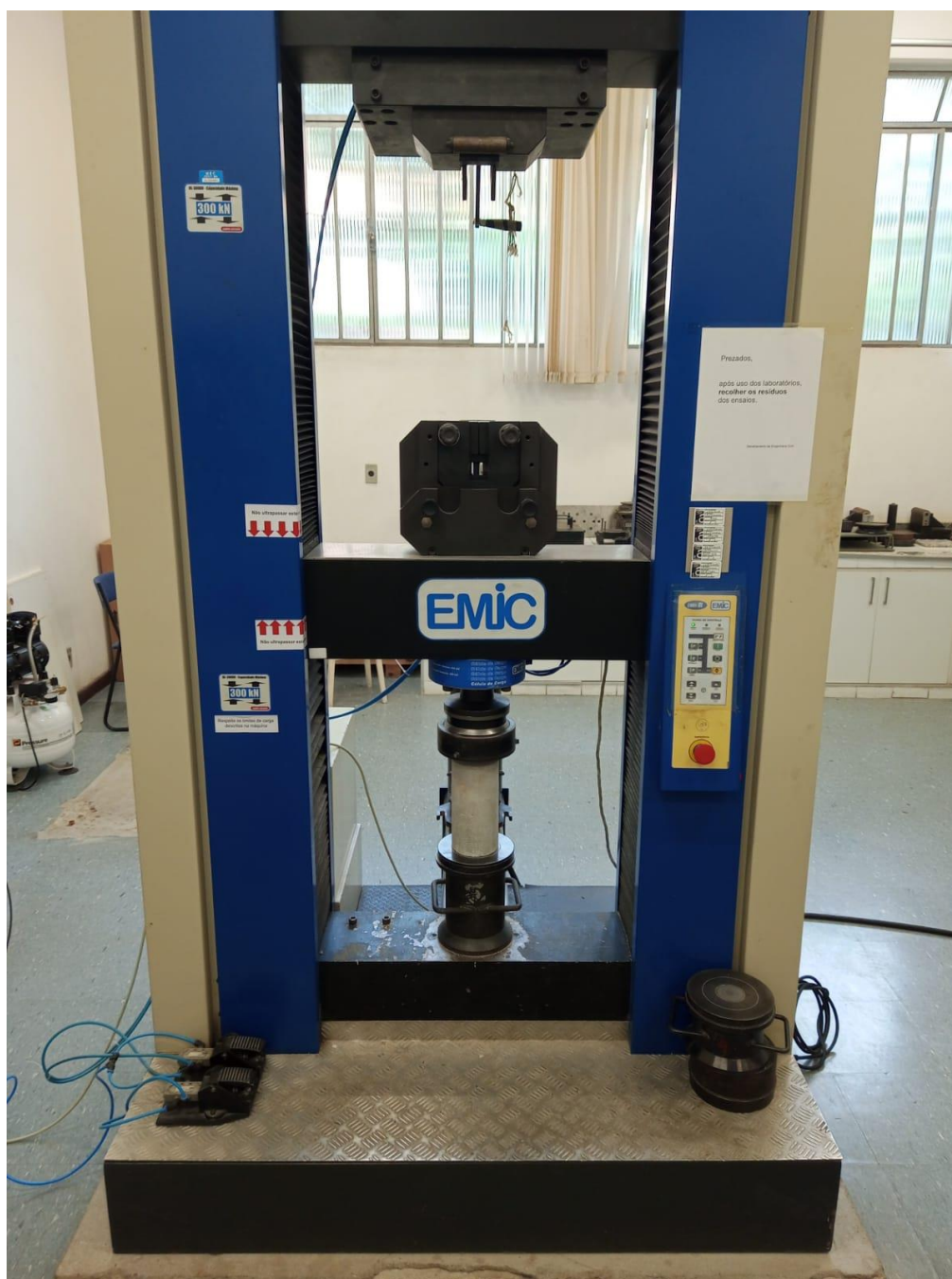
Figura 16 - Máquina Universal de Ensaios.
