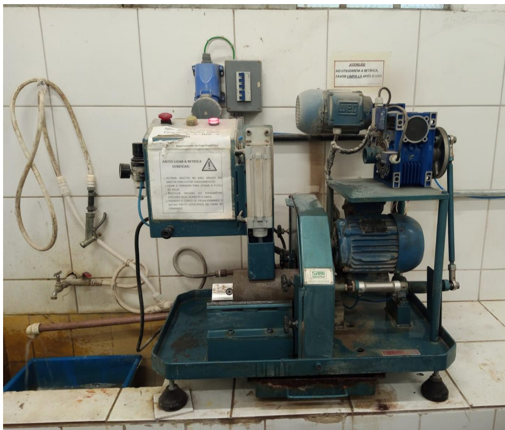
Figura 15 - Retífica de corpos de prova de concreto.
