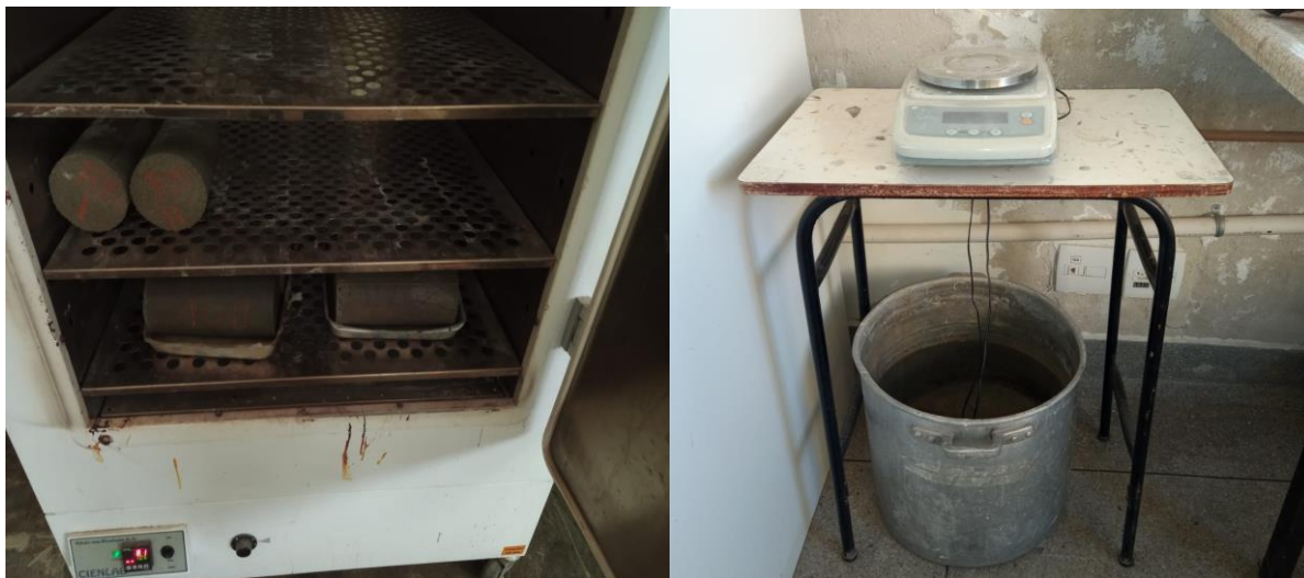
Figura 17 - Amostra na estufa (a), Imersão na balança hidrostática (b).
