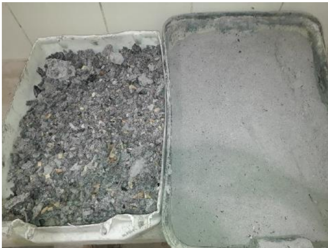
Figura 5 - Amostras de CBCA natural (esquerda) e amostra peneirada (direita).
