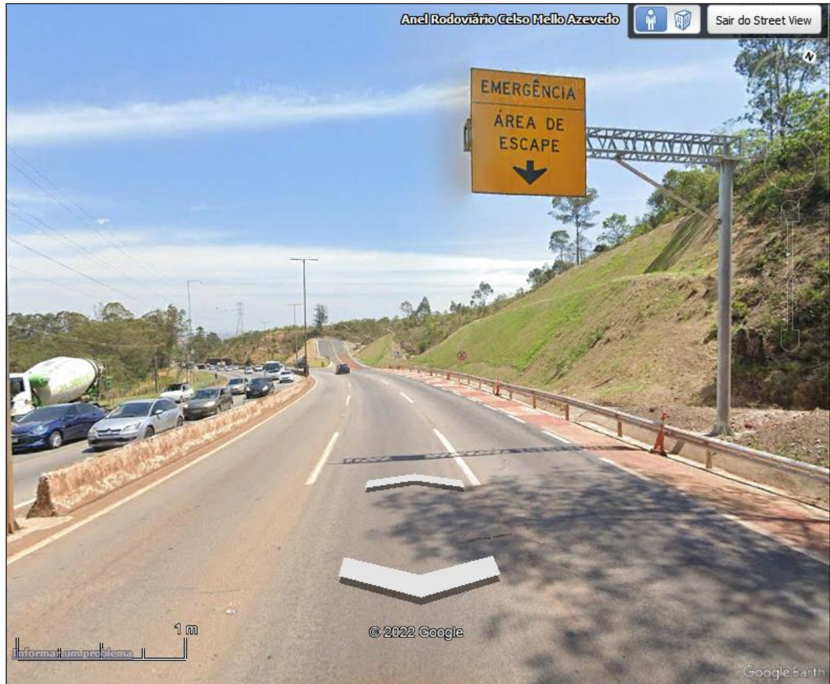
Figura 10 – Rampa de Escape – Greide Ascendente – Brasil Minas Gerais - Anel Rodoviário Celso Mello Azevedo, 5046 - Olhos D'Água Belo Horizonte - MG - (BR-040/MG, km541), Latitude: 19°59'19.20"S, Longitude: 43°58'18.28"O.
