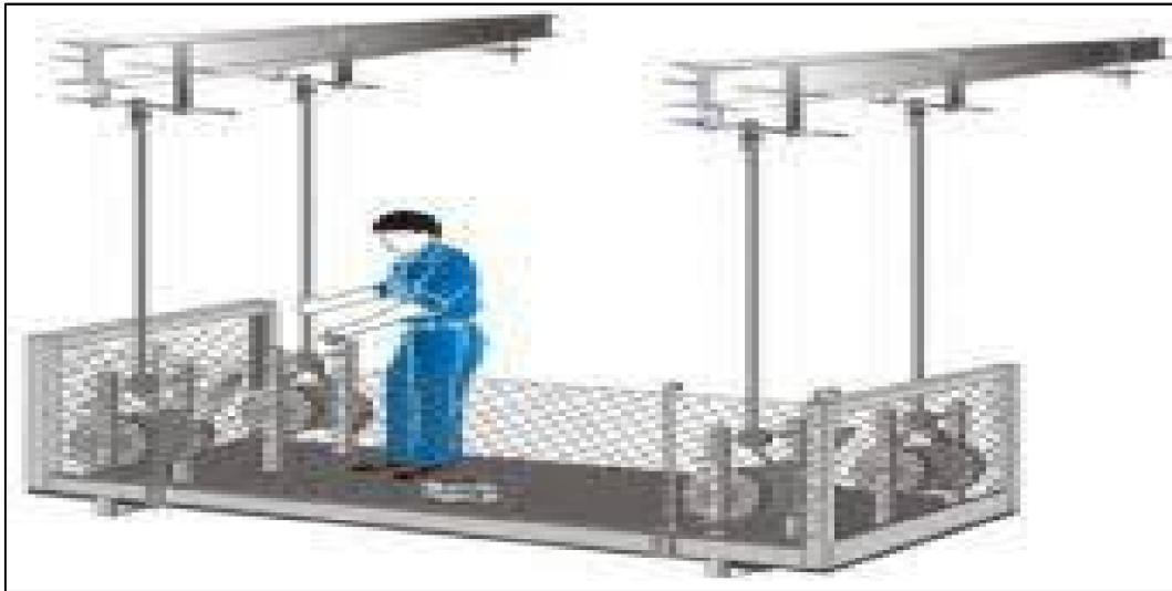
Figura 6 – Andaime suspenso mecânico pesado
