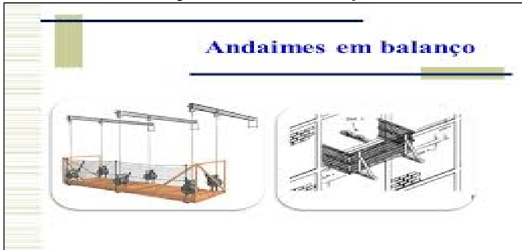
Figura 8 – Andaimos em balanço
