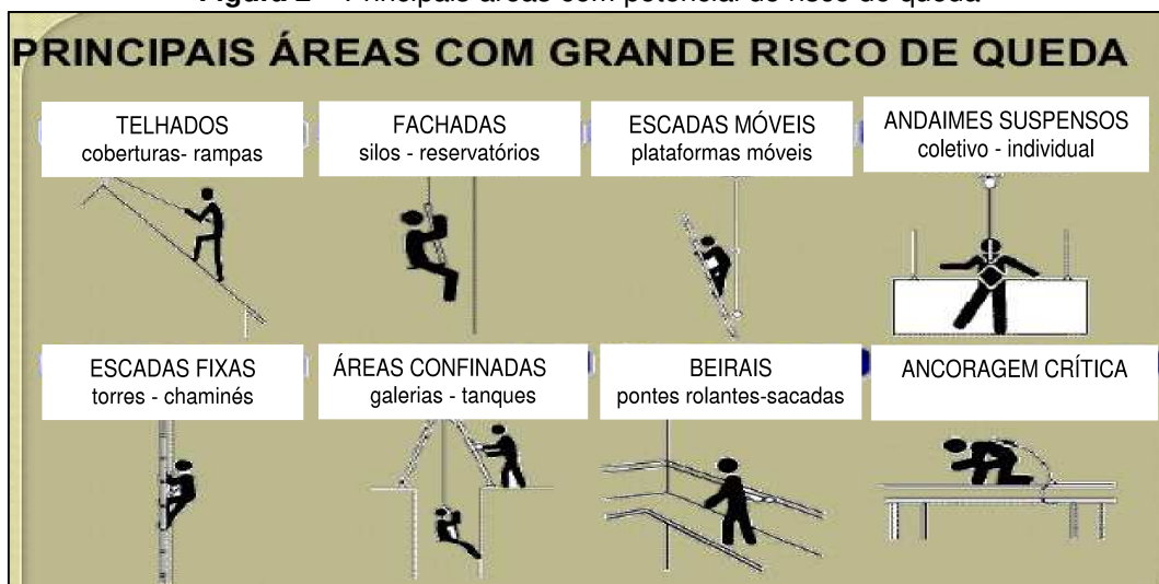
Figura 2 – Principais áreas com potencial de risco de queda
