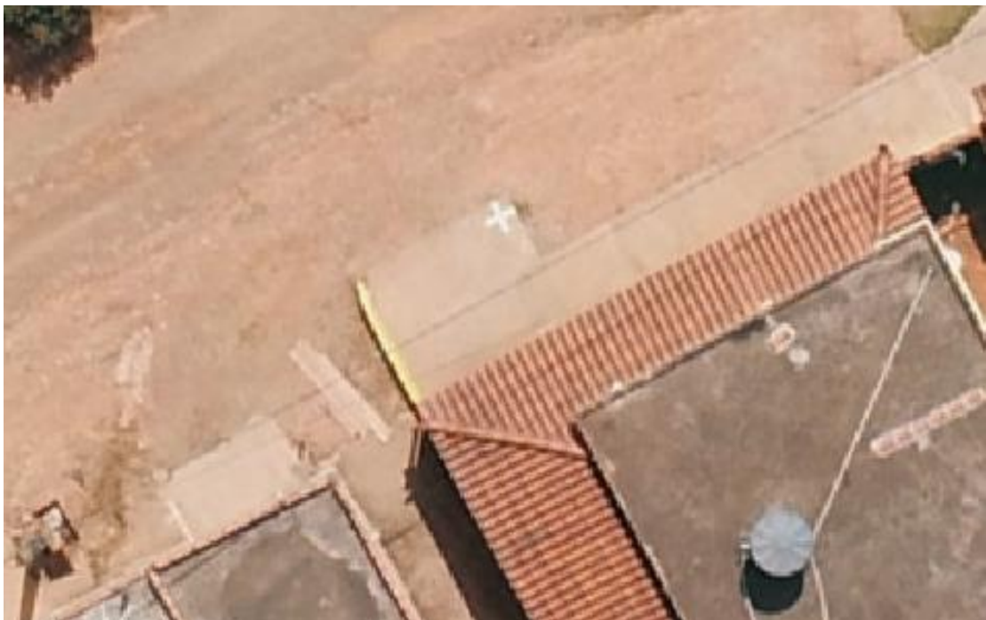
Figura 07: Ponto de Controle - GCP
