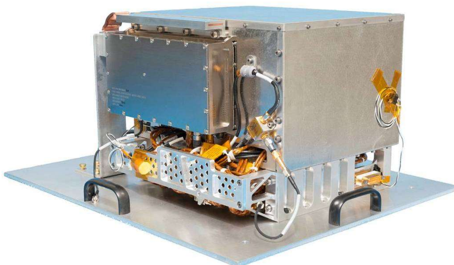
Figura 9 – Relógio atômico GPS. Fonte: HARBAUGH (2018)
