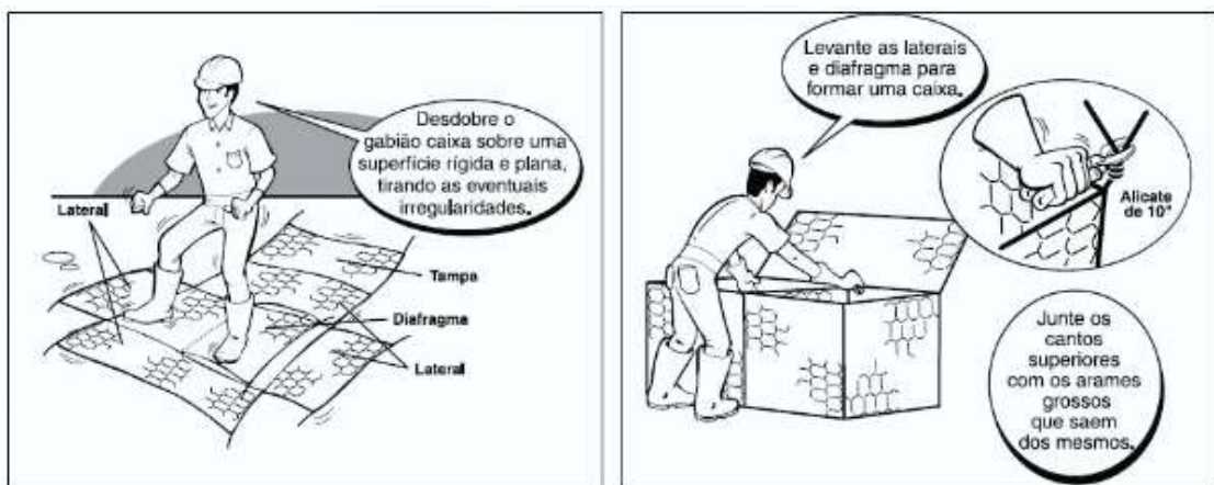
Figura 2.13: Preparação do gabião, parte 1
