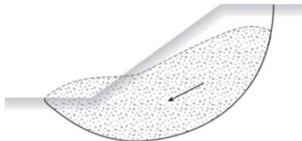
Figura 4: Escorregamento de talude
