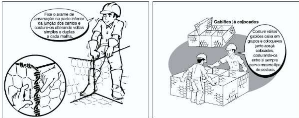
Figura 2.14: Preparação do gabião, parte 2
