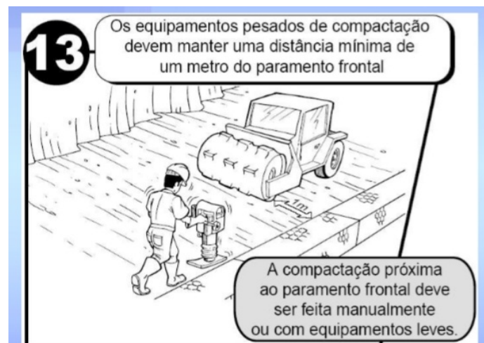
Figura 21: Método de compactação de terramesh
