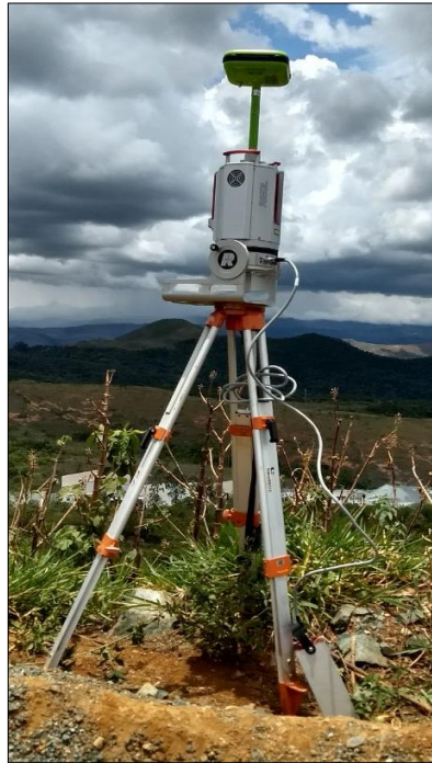
Figura 22 - Receptor GNSS acoplado ao Laser scanner
