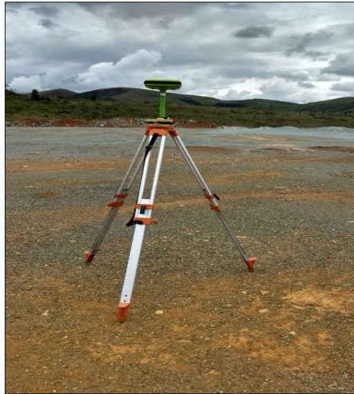
Figura 18 - Receptor GNSS (Base) instalado em campo
