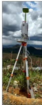
Figura 4: Receptor GNSS acoplado ao Laser scanner Fonte: Elaborado pelos autores, 2018.
