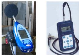
Figura 1: Exemplo de aparelhos utilizados para medição do ruído, sonômetro e dosímetro
