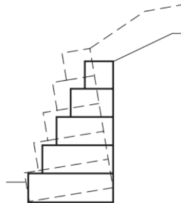
FIGURA 31 - TOMBAMENTO DO MURO DE ARRIMO
