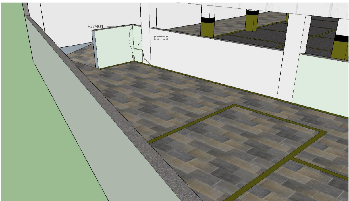
Figura 43 – Projeto da trinca no muro de contenção e desnível entre os estacionamentos 1 e 2
