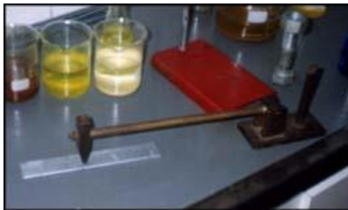
Figura 4 – Teste de verificação de aderência do revestimento de zinco
