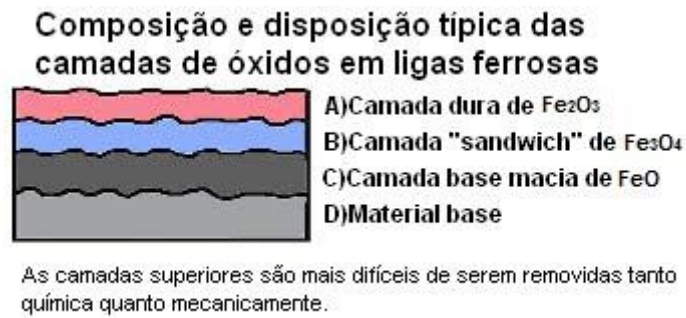
Figura 7 - Camadas de oxidação do ferro
