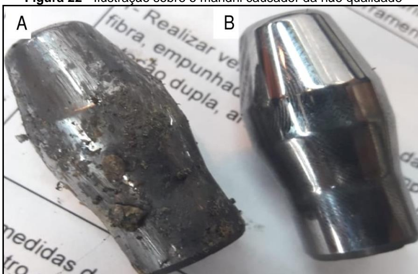
Figura 22 - Ilustração sobre o mandril causador da não qualidade
