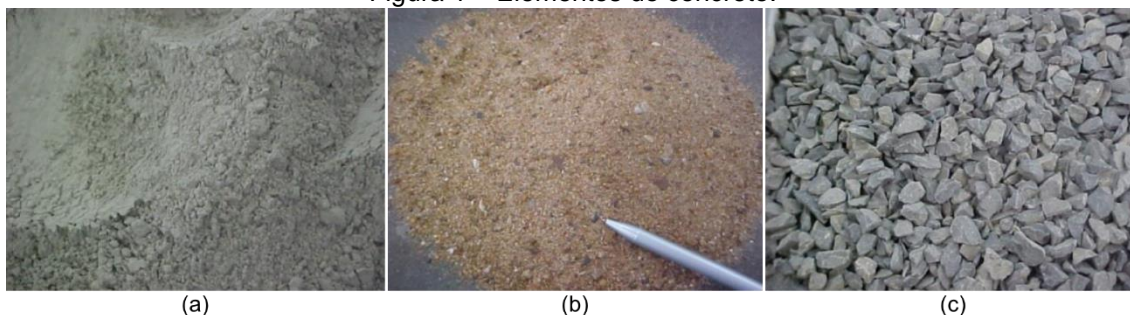
Figura 1 – Elementos do concreto.
