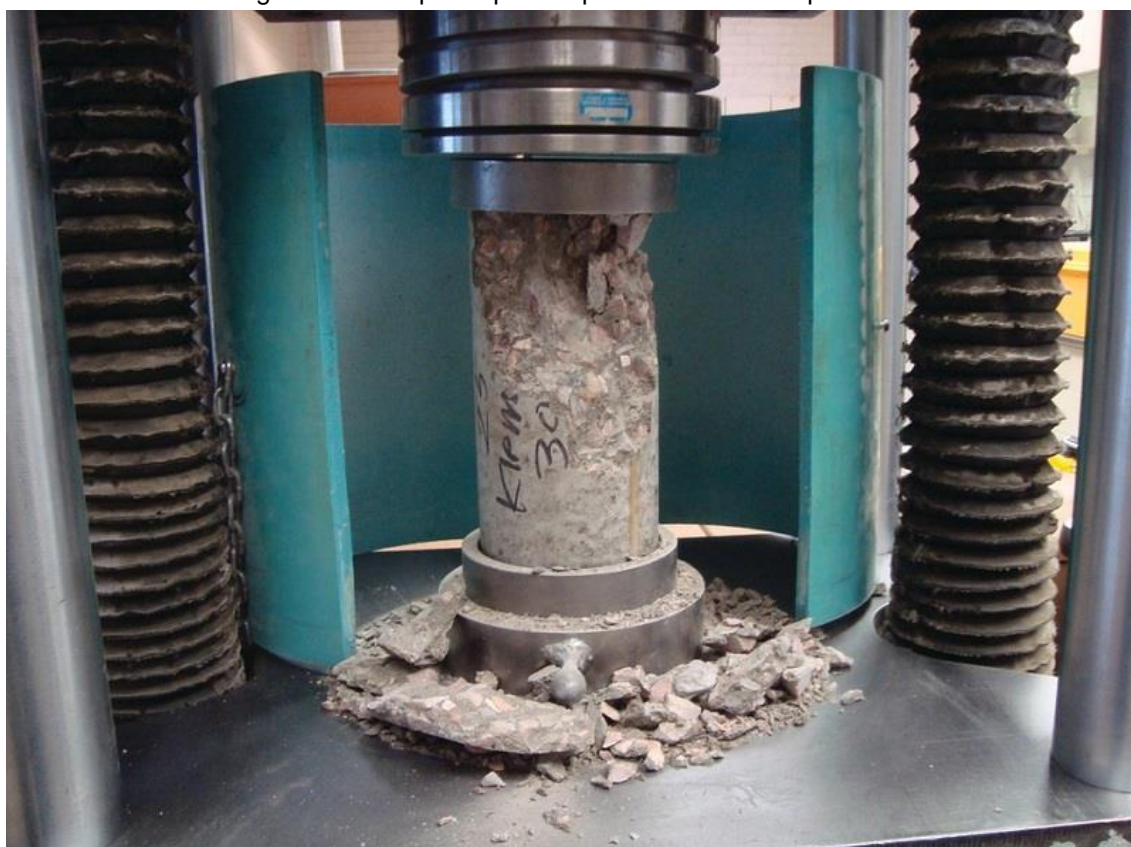
Figura 25 – Corpo de prova após o teste de compressão.
