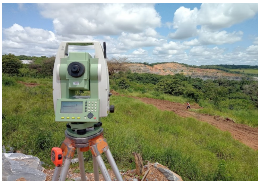
Figura 01 – Estação Total, Matozinhos
