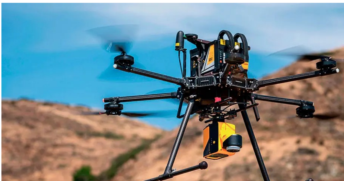
Figura 06 – Drone com sensores LiDAR
