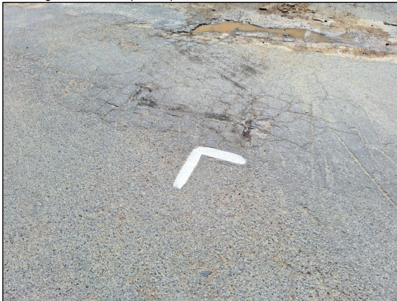
Figura 9 – Exemplo de ponto de controle artificial utilizado
