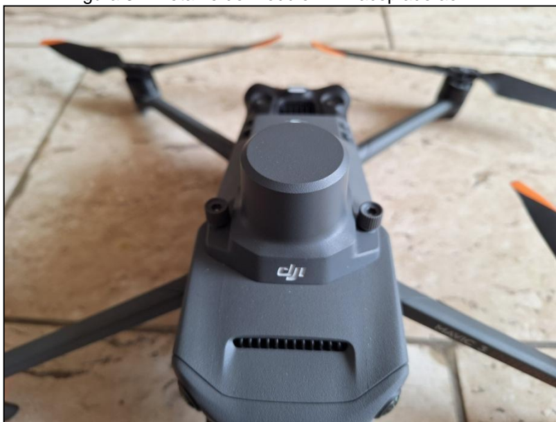
Figura 3 – Detalhe do módulo RTK acoplado ao RPA
