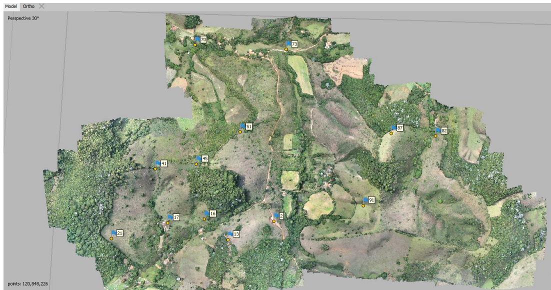
Figura 4 - Ortomosaico processado com ponto de controle sinalizado no solo.
