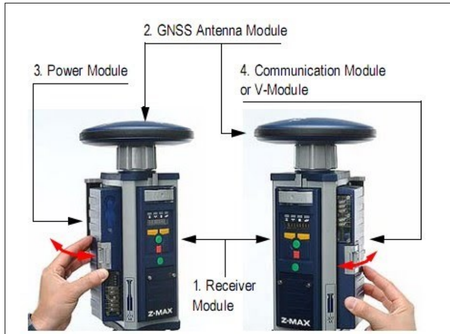
Figura 4 - Remoção da bateria do Receptor GNSS Z-Max da Thales Ashtech. Fonte: Surveying Equipment Guide.
