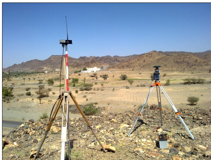
Figura 3 - Exemplo do uso de bateria automotiva (lado inferior direito) como apoio ao posicionamento pelo GNSS. Fonte: Land Surveyors United.
